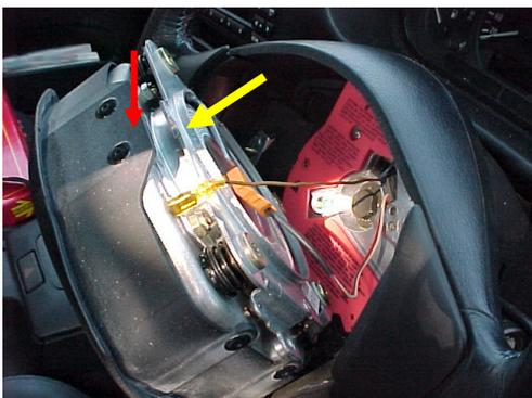
SRS本体モジュールを外し、裏側のSRSソケットとホーン用配線を外して下さい。
