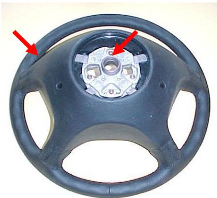
純正ステアリングホイールの裏側2ヶ所の穴からトルクス (T30) を使用してボルトを緩めて下さい。
