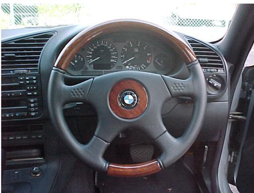
17、バッテリー端子を接続して、ウインカー、ホーンのテストをしてエンジンをかけてSRSモニターランプが消灯するのを確認して下さい。
