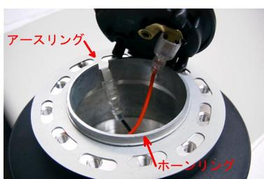
アースリングにホーンリングを用い、アースリング付属線とアース線（**緑**）を接続し、ホーンボタンに**赤**線を接続して下さい。
