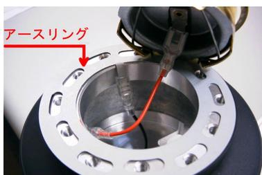
アースリングと配線のみご使用下さい。尚、ナルディサイズのホーンボタンは、ボスに挿入する際、スプリングをマイナスドライバー等で抑えながら挿入してください。プラスチック製の物は、多少削れながら挿入されます。
