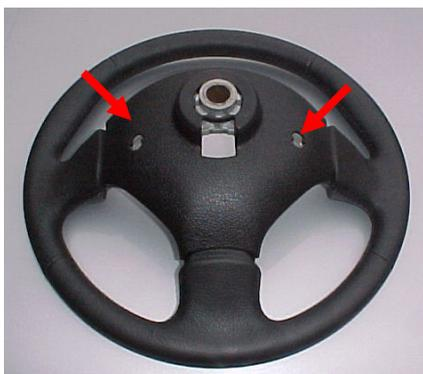
純正ステアリングホイールの裏側2ヶ所の穴からトルクスレンチ（T30）を使用してボルトを緩めて下さい。
