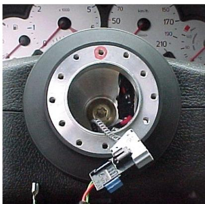
SRS ハーネスとホーンハーネスをボスの穴から通し、トップマークを上にしてボスを装着して、NO.6 で外したカプラーを差込み (206/406 のみ) センターボルトを軽く締めて下さい。
