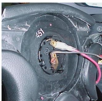
車体側から出ているホーン線（**緑色**）と変換ハーネスを取り付けた線をホーンキャップの2つの端子に差し込んで下さい。（写真は別の車種です）1極のホーンボタンは15へ
