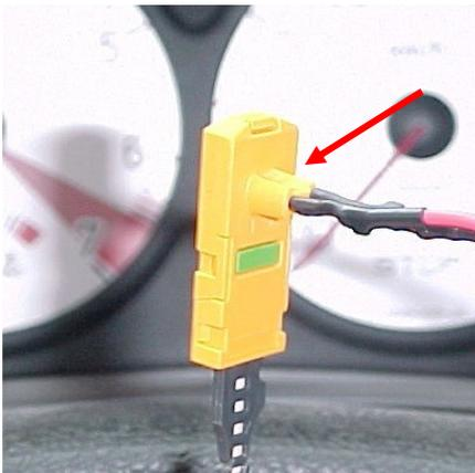
付属のジャンパー線をSRSコネクターの2ヶ所の穴に挿入し
