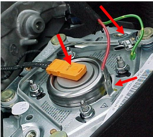
SRS本体モジュールを外し、裏側のSRSソケットとホーン用配線2ヶ所を外して下さい。エアバックのカプラーは矢印の部分がロックになっていますので、小型のマイナスドライバ等で引っ張りあげればロックが解除され、取り外せます。
