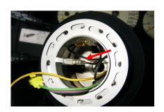
向かって右側のコード穴から配線をハンドル側に引き入れて下さい。1極タイプのホーンボタンをご使用の場合には、車両の黒線(アース)に付属の変換コードを用いて付属アースリングへ接続してください。
