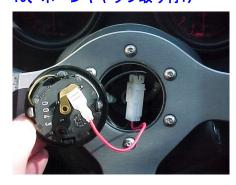
前項で取り付けた変換コード(赤色)をホーンキャップの端子に差し込んで下さい。 (写真は別の車種です)
