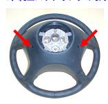
純正ステアリングホィールの裏側 2ヶ所の穴からトルクスレンチを使用してボルトを緩めて下さい。
