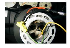
SRSコネクタに付属のヒューズ付きジャンパー線を差し込んで、抜けないようにビニールテープ等で固定して下さい。(2極間で極性はありません) 車両からの黄色の線には付属の変換コード(赤色)を接続してください。
