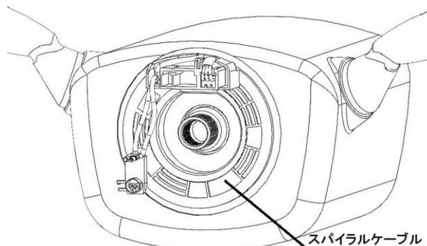
注意！センターボルトを取外した後に、ステアリングシャフトの時計 12 時方向にマジック等でマークを付けてください。後に TOP の位置が分かりやすくなります。
