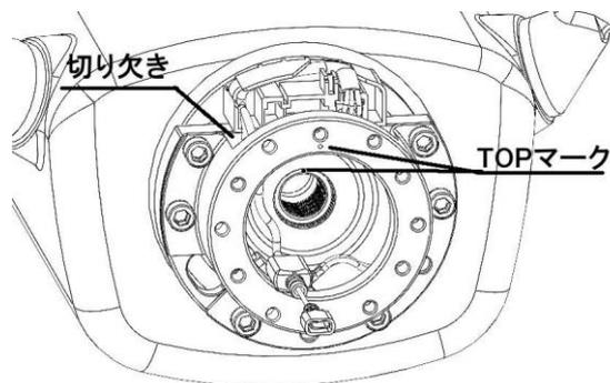
9. センターボルトを締付けます。手順2で外したボルトを再使用して下さい。締付けトルクは 50N・m(5kgf・m)です。必要であれば取付けようとするスポーツステアリングホイールを仮付けしておいて下さい。
