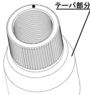
6. 出荷状態でボスに被さっているボスカバーをボスから外して下さい。
