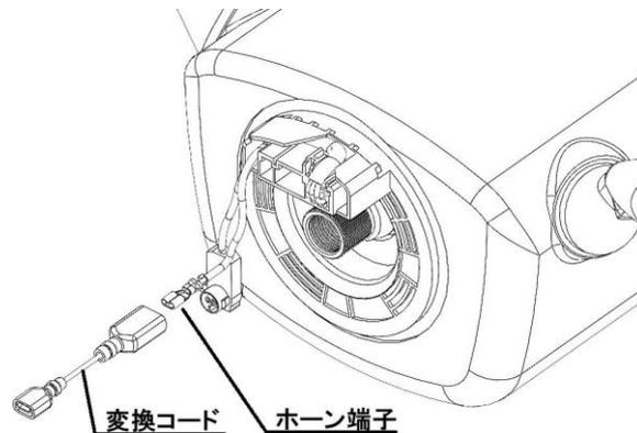
4. 本製品付属のエアバッグジャンパー線の端子をスパイラルケーブルから出ているエアバッグコネクタにそれぞれ挿して下さい。このとき、抜け防止及び接触不良がおきないように必ず絶縁テープ等で固定して下さい。2 本の端子の極性(プラスマイナス)はありません。
