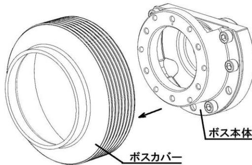
7. ステアリングボスの TOP マークを時計 12 時方向にし、車体側にある切り欠きから手順3及び手順4で作業した配線をボス内部に引き込んで下さい。(ステアリングヒーター装着車はヒーター用コネクタも内部に引き込んで下さい。)
