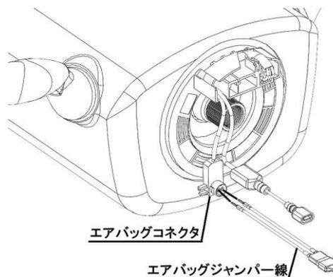
注意！固定作業をしないと接触不良等でエアバッグの警告灯が点灯してしまうことがあります。警告灯点灯(点滅)状態では車検に合格することが出来ません。
