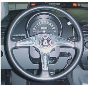
15、バッテリー端子を接続して、ウインカー、ホーンのテストをしエンジンをかけてSRSモニターランプが消灯するのを確認して下さい。
