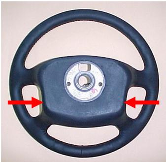
純正ステアリングホイールの裏側2ヶ所の穴からトルクスレンチ（T30）を使用してボルトを緩めて下さい。（終了後、NO.5へ進んで下さい。）
