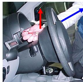
ステアリングを左右どちらか 90 度切ってステアリングホイールの裏側の穴へ細いマイナスドライバーを差込、上方 → 方向へカバーが変形する位、引き上げて下さい、SRS ユニッ
