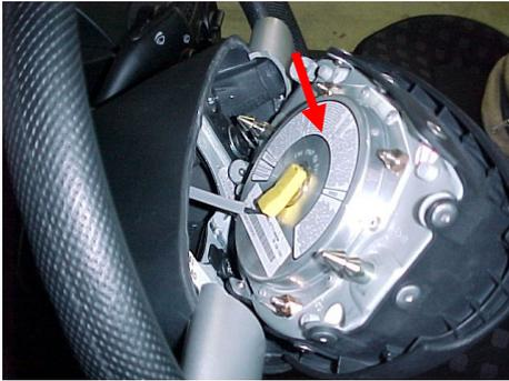
ステアリングを直進状態に戻し、SRS本体モジュールを外し、裏側のSRSソケットを外して下さい。
