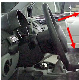
ステアリングコラム下のテレスコピック及びチルトレバーを調整してステアリングを一番手前の一番下にセットして下さい。
