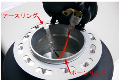
アースリングにホーンリングを用い、アースリング付属線とアース線を接続して下さい。ホーンボタンに変換線を用いスパイラルケーブルからの配線に接続して下さい。
