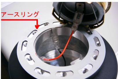
アースリングと配線のみご使用下さい。尚、ナルディサイズのホーンボタンは、ボスに挿入する際、スプリングをマイナスドライバー等で抑えながら挿入して下さい。プラスチック製の物は、多少削れながら挿入されます。
