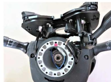
9、取付ステアリングに合わせてウイングの位置を決め、7、で仮締めした⑤サラ CAP ボルト M5×10 を 4 本増し締めしてください。
